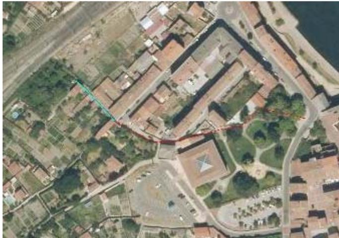
*Tramo del canal a cielo abierto (azul) y soterrado (rojo).*
